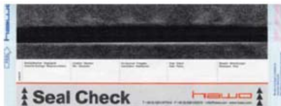
Figura 1 - Indicador de selagem mostrando correta faixa de selagem sem vincos, bolhas ou falhas.
