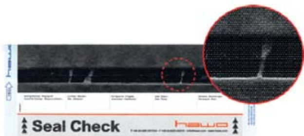
Figura 2 - Indicador de selagem mostrando falha de selagem, muitas vezes imperceptível sem o uso do indicador.
